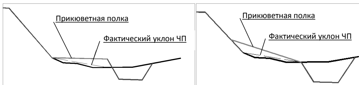
Рис. 5. Устройство прикюветной полки с требуемым уклоном, с возможной присыпкой
