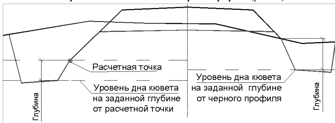
Рис. 13. Начало кювета слева – расчетная точка, справа – точка пересечения откоса с ЧП
