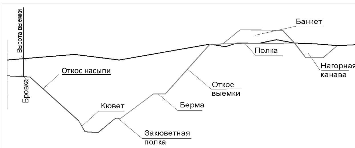
Рис. 26. Поперечник земляного полотна в выемке
